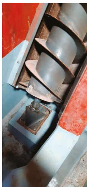
Palier inférieur vis de relevage STAR
